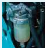
Pré filtro de combustível com a função de separador de água
